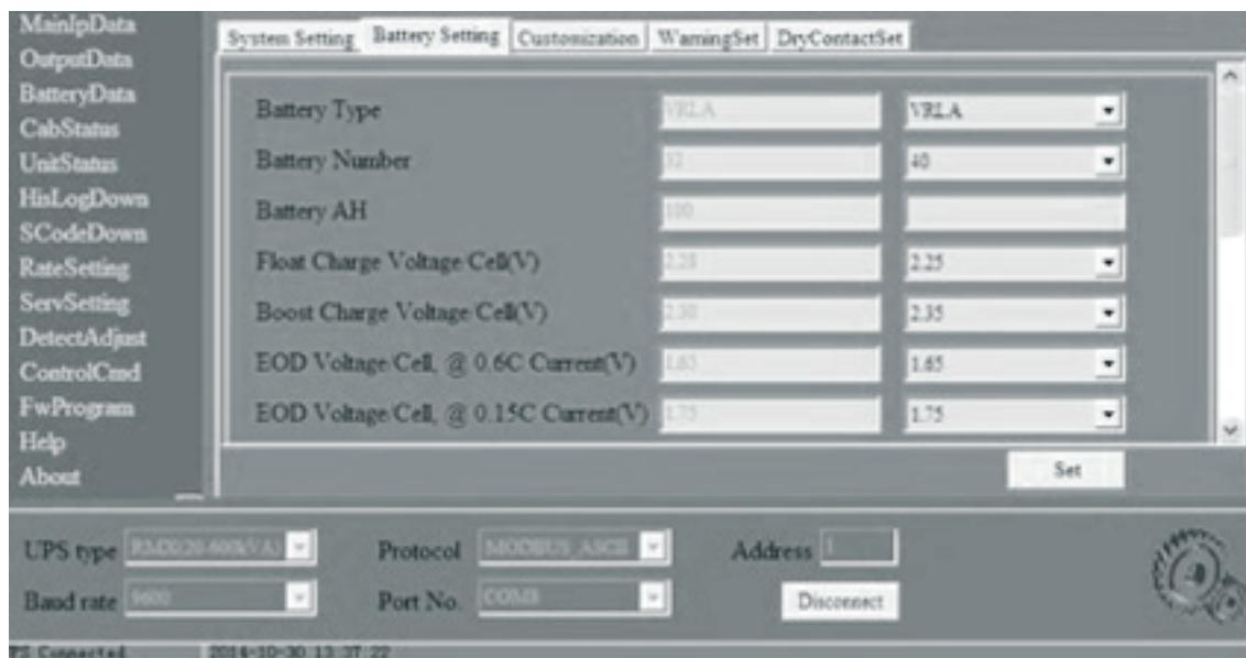
Рисунок 5-2. Конфигурация с помощью программного обеспечения для мониторинга
