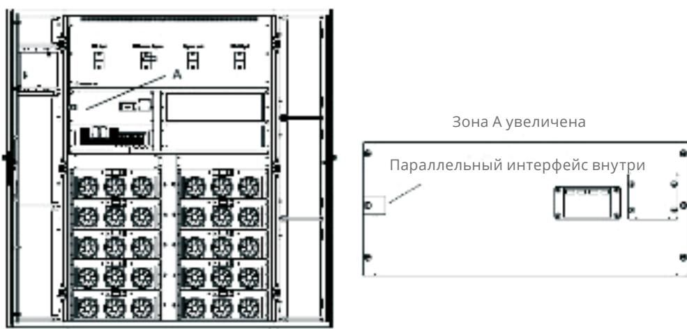
(б) Параллельные интерфейсы у шкафов с 10 слотами
