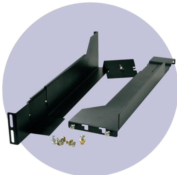
Монтажный комплект креплений – направляющих для установки ИБП высотой 3U в 19" стойки. Благодаря высокой нагрузочной способности до 95 кг подходит для любого ИБП или батарейного кабинета, предназначенного для установки в телекоммуникационную стойку. Регулируются по длине для любой глубины стойки от 500 до 800 мм. В комплект входят крепежные элементы.
