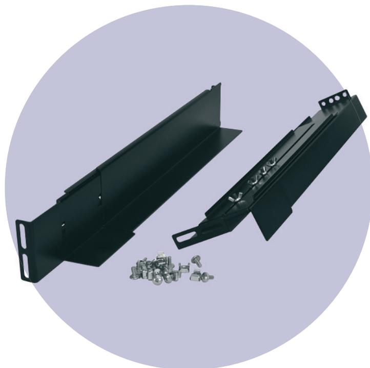
Монтажный комплект креплений – направляющих для установки ИБП высотой 2U в 19" стойки. Нагрузочная способность до 43 кг позволяет использовать с любым ИБП или батарейным кабинетом, предназначенным для установки в телекоммуникационную стойку высотой 2U. Регулируются по длине для любой глубины стойки от 500 до 800 мм. В комплект входят крепежные элементы..
